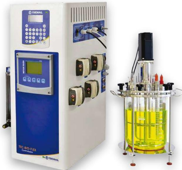
Utilizado para el cultivo de células y microorganismos. Sistema de control robusto con sensores digitales, módulos opcionales que posibilitan el control de temperatura, pH, O<sub>2</sub>, CO<sub>2</sub>, presión, turbidez, agitación, entre otros.
