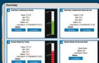
Mediante una página web se accede al status y al historial. El Web600 tiene un servidor web incorporado que ofrece acceso rápido e información sobre sus condiciones controladas.
