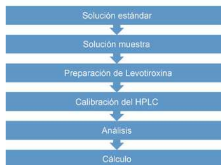
Figura 10. El diagrama de operaciones unitarias para la valoración también puede usarse para ayudar en la identificación de componentes de la incertidumbre.
