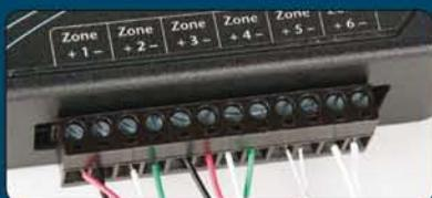
Conecta hasta 6 sensores externos, controlando diferentes equipos y condiciones ambientales. Cada input se puede conectar a un sensor de temperatura, un transductor analógico, o un interruptor de contacto seco.
