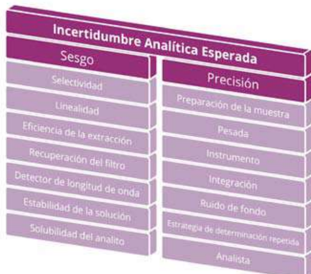
Figura 2. Consolidación de los atributos que contribuyen con la incertidumbre esperada de la medición a través de la exactitud (sesgo) y la precisión.
