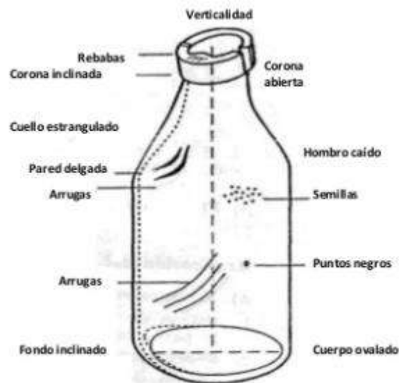
Defectos varios en un frasco que conforman una unidad defectuosa
